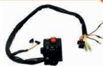
INTERRUPTOR DE PARTIDA E EMERGÊNCIA
